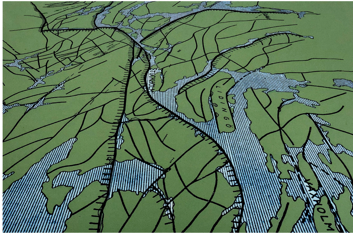
Bild 4: Kartbild från boken "Stockholm, vattnet, öarna och staden", P. Kallstenius/J. Wikström, 2018. Bilden visar förkastningslinjer och sprickdalar i Stockholms topografi, sett från öster. Den kraftigt välvda linjen är en del av den långa brant som inne på Södermalm bildar Åsöberget, Katarinaberget, Mariaberget och Skinnarviksberget.
